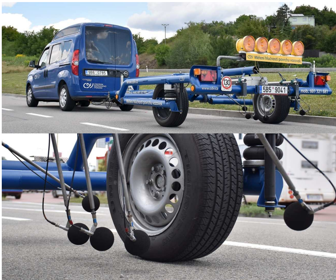
Měření a vyhodnocení hlučnosti povrchů pozemních komunikací
