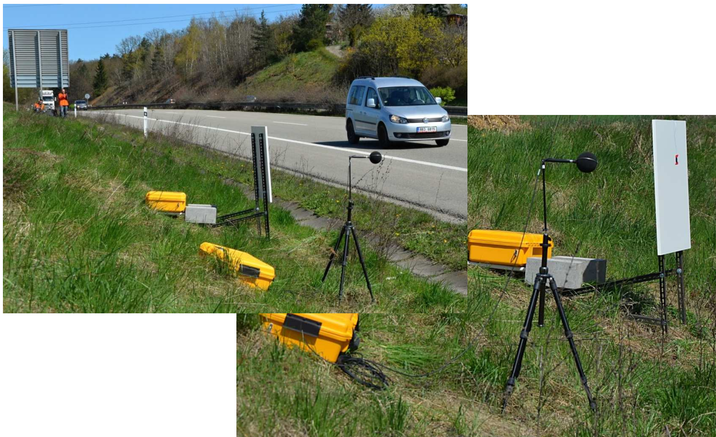
Měření a vyhodnocení hlučnosti povrchů pozemních komunikací
