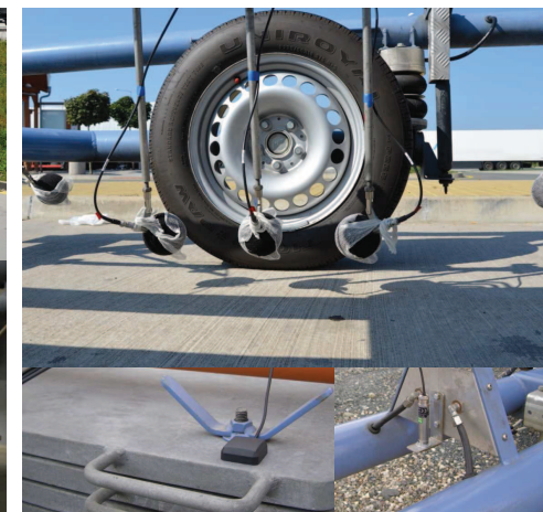
Měřicí vybavení umístěné na přívěsu, detaily.
