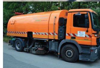
Specializovaný čistící vůz SR (čištění vysokotlakým proudem vody)
