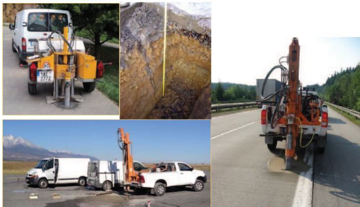
Odběr jádrových vývrtů, a provádění hloubkových sond
