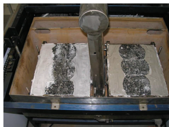
Výsledky zkoušky z odebrané vrstvy (ČSN EN 12697-22 při 50°C)
