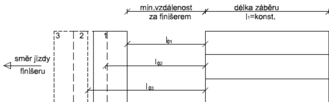
Obrázek 5.7: Schéma k hutnění s kolmým ukončováním jednotlivých jízd válce (tzv. obdélníkové pole)
